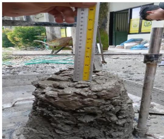
Gambar 4 Hasil Test Slump Dengan Campuran 5%
