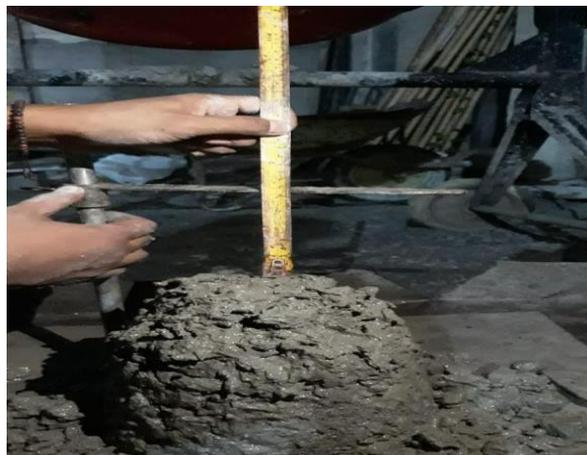
Gambar 3 Hasil Test Slump Non Campuran
