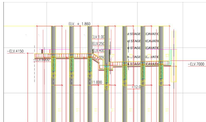
Gambar 6 Potongan shop drawing / 2D pondasi CSP yang menunjukkan elevasi kepala tiang sebelum pembobokan.
