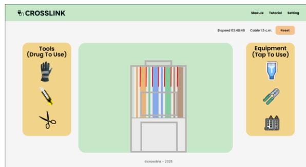
Gambar 4. Pemasangan RJ45 Connector pada Kabel UTP
